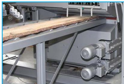
Abb. 21: elektrische Sägeblattverstellung
