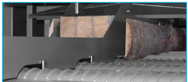
Abb. 19: Spreißelabscheider mit Trennlamelle
