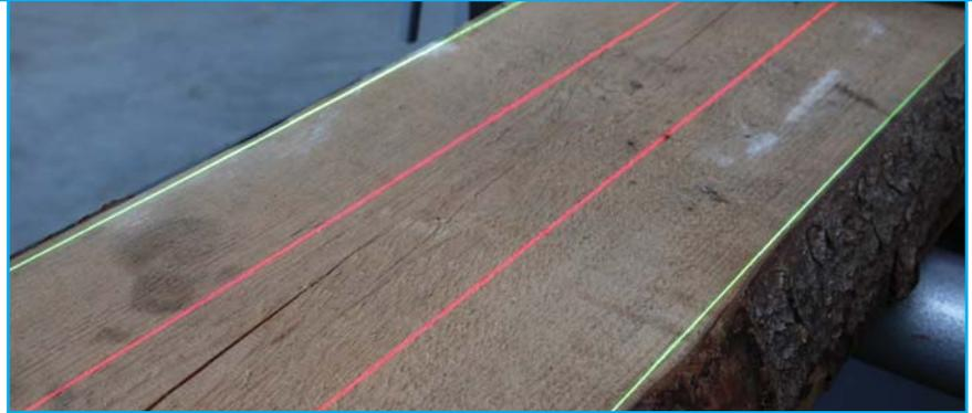
Abb. 15: Linienlaser zur einfacheren Ausrichtung der Werkstücke
