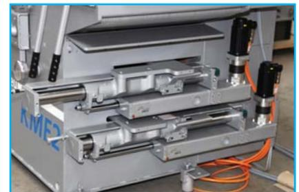
Abb. 22: servomotorische Sägeblattverstellung
