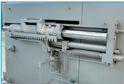
Abb. 20: hydraulische Sägeblattverstellung
