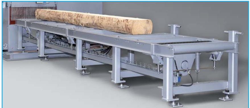
**Abb. 17:** Komfortabler Ausrichttisch mit manueller Beschickung
