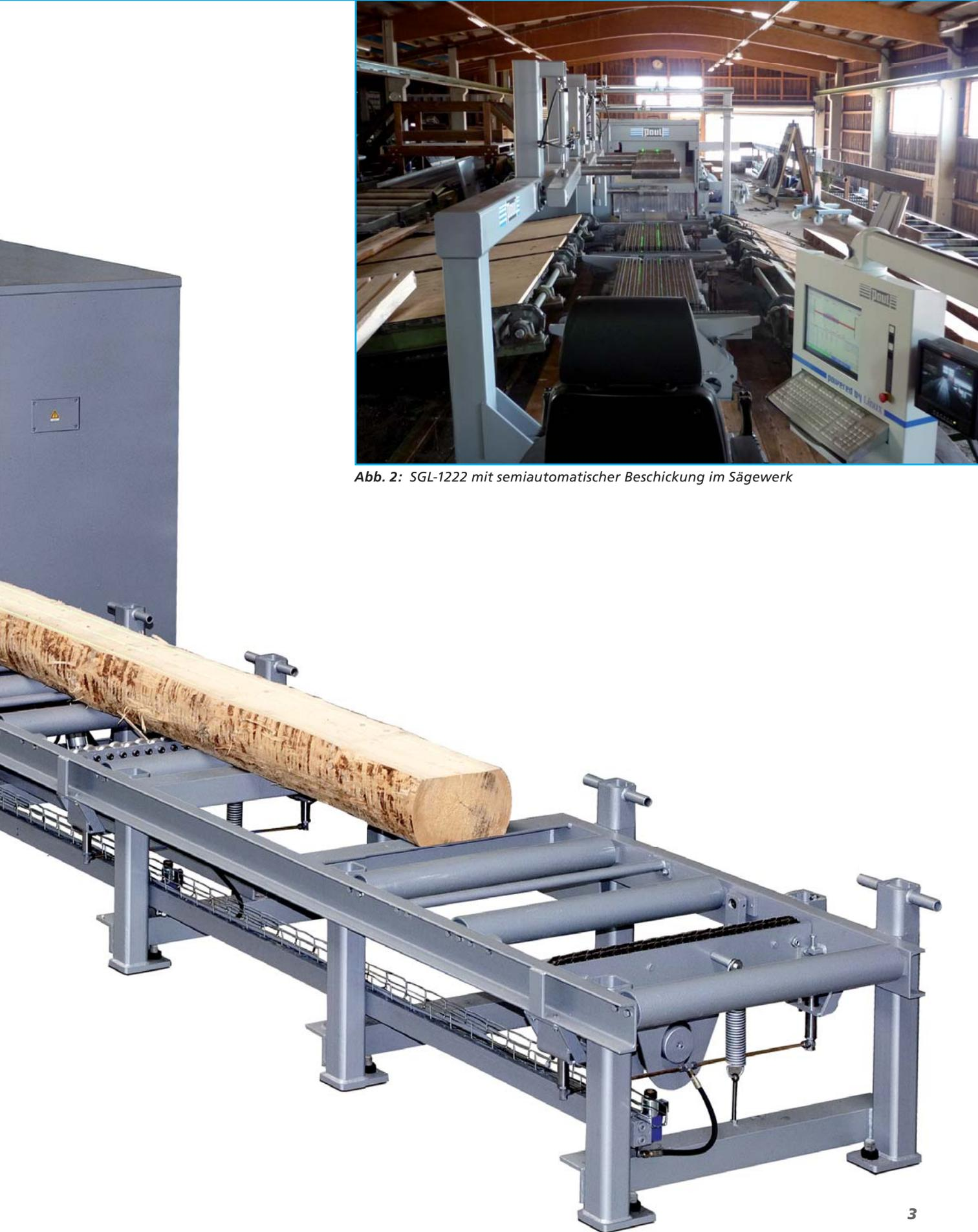
Abb. 2: SGL-1222 mit semiautomatischer Beschickung im Sägewerk
