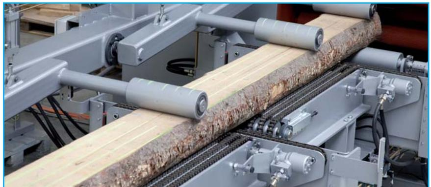
**Abb. 16:** Semiautomatische Beschickung
