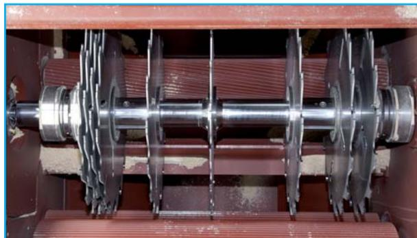
Abb. 11: Teleskopische Sägebüchsen-Anordnung für 4-stieligen variablen Einschnitt
