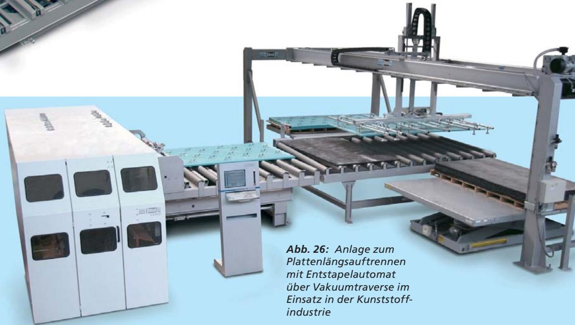
**Abb. 26:** Anlage zum Plattenlängsauf-trennen mit Entstapelautomat über Vakuumtraverse im Einsatz in der Kunststoff-industrie
