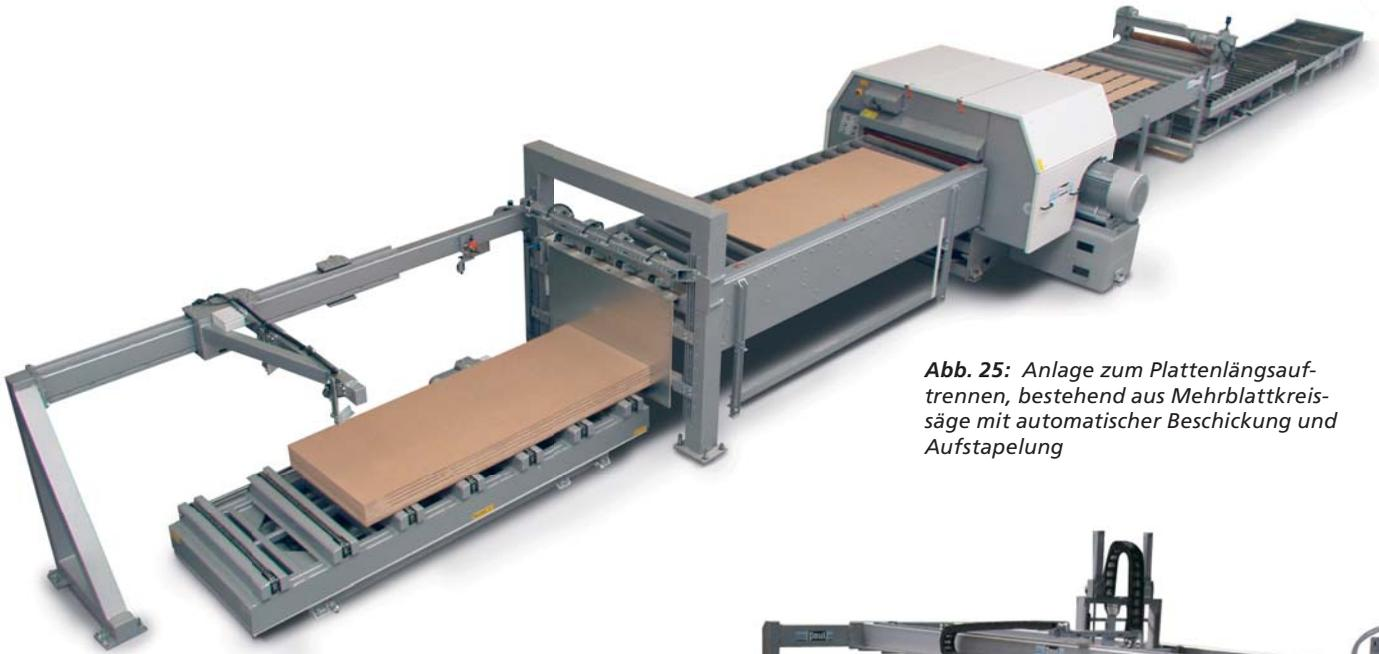
**Abb. 25:** Anlage zum Plattenlängsauf-trennen, bestehend aus Mehrblattkreissäge mit automatischer Beschickung und Aufstapelung
