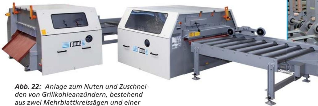
**Abb. 22:** Anlage zum Nuten und Zuschneiden von Grillkohleanzündern, bestehend aus zwei Mehrblattkreissägen und einer Winkelübergabe
