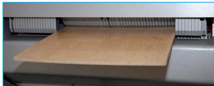
Abb. 7: Rückschlagsicherung
