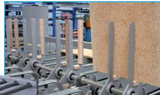
**Abb. 23:** Automatische Wendeeinheit für Plattenmaterial
